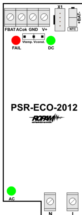
Widok PCB zasilacza PSR-ECO-2012
